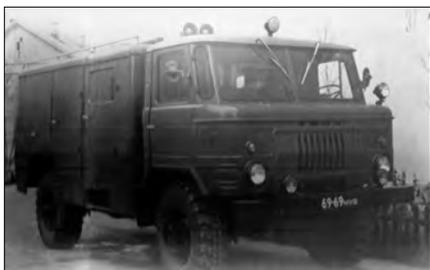
*ГАЗ-66 - автомобиль оповещения и связи.*
